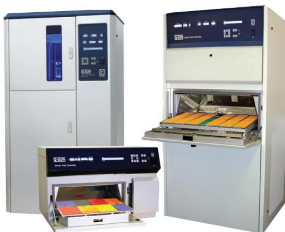
图十. Q-SUN 氙灯老化试验箱实物和测试图
