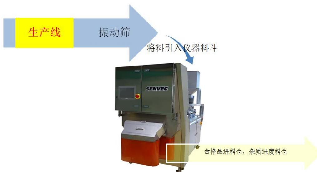
图五：在线工作示意图
